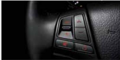
**Кнопки управления аудиосистемой на рулевом колесе** Удобно расположенные кнопки дистанционного управления аудиосистемой позволяют одновременно следить за дорогой и регулировать громкость, выбирать треки, переключать режимы и заглушать звук.
