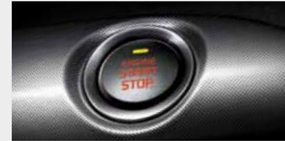
**Кнопка запуска/выключения двигателя** Система пуска двигателя одной кнопкой позволяет завести двигатель простым нажатием, если ключ лежит у Вас в кармане или сумке.
