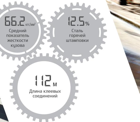
**1 Феноменальная жесткость** Новые технологии высокопрочных kleевых соединений для кузовных панелей и элементов каркаса, повышение жесткости кузова и усовершенствованные конструкции, распределяющие силу удара при столкновении, позволяют новому KIA Soul защитить водителя и пассажиров в максимальной степени.
