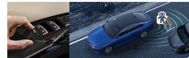
**Система безопасного выхода (SEA)** Используя радары в задней части Kia K5, система SEA отслеживает приближающиеся сзади автомобили и предупреждает пассажиров, которые могут выйти из машины. Система также активирует электронный замок безопасности для детей, пока приближающийся автомобиль не проедет мимо.
