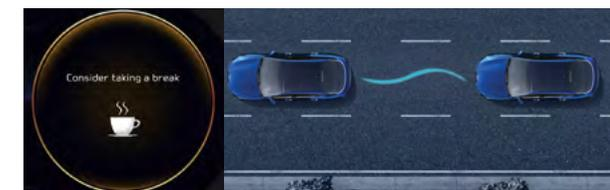
**Система контроля внимания водителя (DAW)** Система DAW анализирует Вашу манеру управления. При обнаружении признаков усталости и потери концентрации система подает визуальный и звуковой сигнал, рекомендуя сделать остановку для отдыха. Систему можно настроить в соответствии с Вашими пожеланиями.
