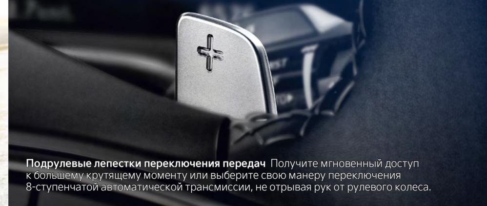
**Подрулевые лепестки переключения передач** Получите мгновенный доступ к большему крутящему моменту или выберите свою манеру переключения 8-ступенчатой автоматической трансмиссии, не отрывая рук от рулевого колеса.
