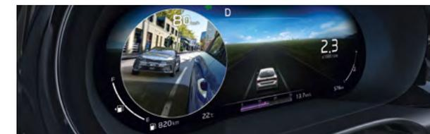
**Монитор для контроля слепых зон (BVM)** Если при включенном сигнале поворота есть вероятность столкновения, система BVM покажет на приборной панели изображение с камеры, предупреждая Вас о возможных помехах в слепых зонах.
