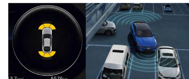
**Передние и задние датчики парковки (PDW)** Чтобы обеспечить Вам спокойное и уверенное маневрирование при парковке в тесных условиях, система использует ультразвуковые датчики в переднем и заднем бамперах, предупреждая Вас о любых препятствиях.
