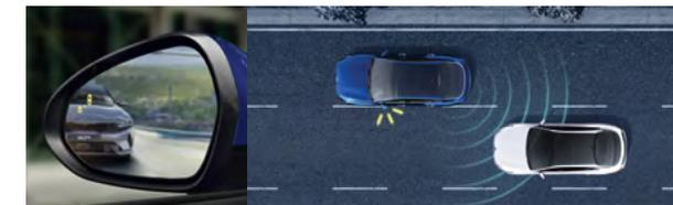
**Система контроля слепых зон (BCW)** На скорости 20 км/ч и выше система BCW предупреждает о появлении автомобиля в слепой зоне, когда Вы меняете полосу движения. Световой сигнал на боковом зеркале и звуковое предупреждение появляются, когда Вы включаете сигнал поворота.
