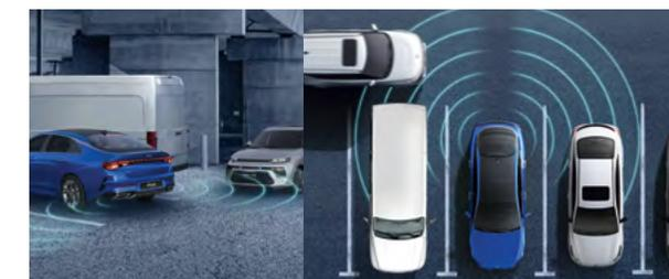
**Система предупреждения при выезде с парковки задним ходом (RCCW)** При выезде с парковки задним ходом система отслеживает объекты, движущиеся в перекрестном направлении. При обнаружении помехи с любой стороны система подает звуковой и световой сигналы, пока объект не проедет.
