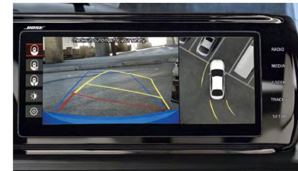
**Система кругового обзора (SVM)** При парковке в ограниченном пространстве несколько камер обеспечивают масштабируемый 360-градусный обзор пространства вокруг автомобиля, чтобы Вы могли уверенно совершить маневр, не выходя из автомобиля.
