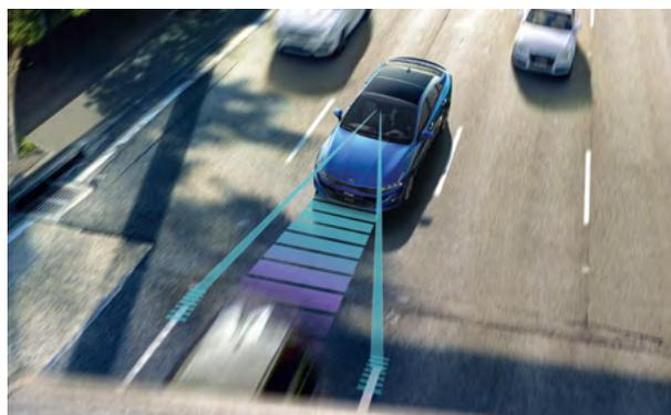
**Интеллектуальный круиз-контроль (SCC) с функцией Stop&Go** Система поддерживает выбранную скорость, используя фронтальную камеру и радар и помогая обеспечить безопасную дистанцию. При необходимости система замедлит и даже остановит автомобиль. Если автомобиль перед Вами через короткий промежуток времени вновь начнет движение, система автоматически разгонит Ваш Kia K5 до заданной скорости. Круиз-контроль можно активировать простым нажатием кнопки.
