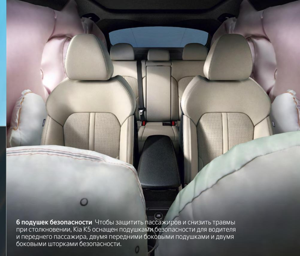
**6 подушек безопасности** Чтобы защитить пассажиров и снизить травмы при столкновении, Kia K5 оснащен подушками безопасности для водителя и переднего пассажира, двумя передними боковыми подушками и двумя боковыми шторками безопасности.
